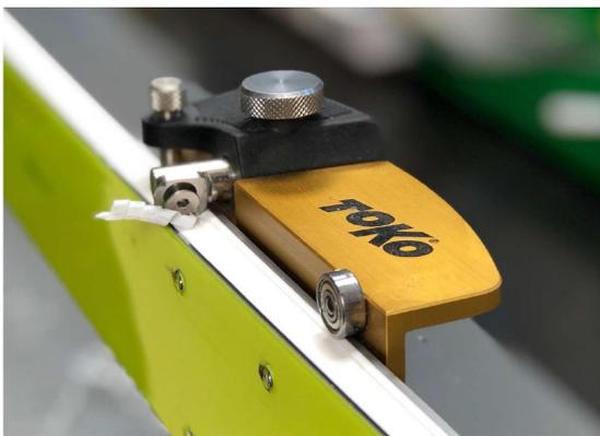
Wird beim Sidewall Planer World Cup das eckige Messer eingesetzt lässt sich die Fläche der Seitenwange perfekt entfernen. Man muss je nach Material oft auch die Messerwinkel etwas anpassen (Schräge des Messers im Hobel)
