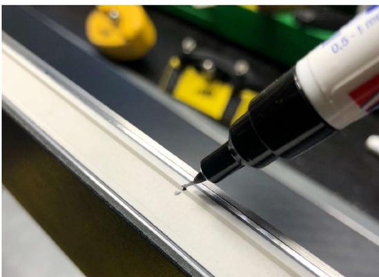
Mit einem Filzstift eine Markierung auf der Seitenwange hilft danach bei der Messereinstellung.
