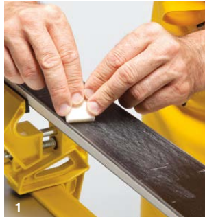
Abb. 1) JetStream Bloc gleichmässig auf dem fertig präparierten Ski / Board mit gleichmässigem Druck aufreiben.
